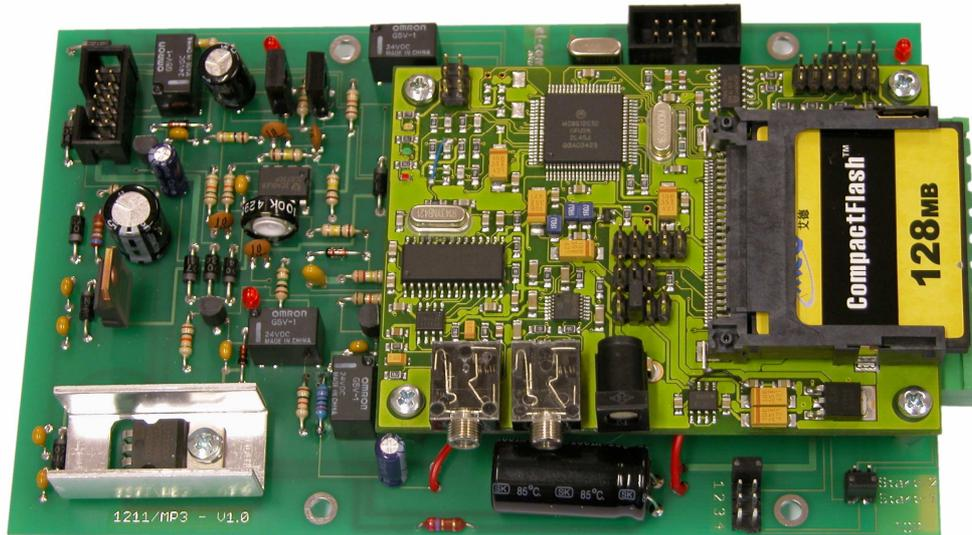
Der Alarm- Signalspeicher verarbeitet MP3 Files. Die Länge der Files ist abhängig von der Größe der Speicherkarte. Mittels Jumperleiste kann selektiert werden ob vor dem Alarmtext (MP3-File Nummer 1-4) ein Aufmerksamkeitssignal (MP3-File Nummer 5) abgespielt werden soll.
