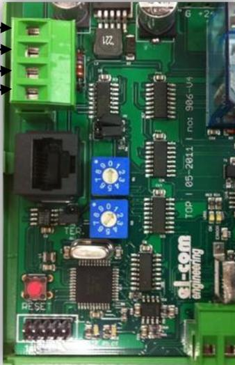
Zwei weitere Module können mittels der RJ45 Buchsen verbunden werden.
