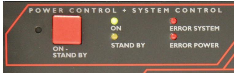
Zusätzlich zur Anzeige wird ein Fehler mit einem akustischen Ton signalisiert. Durch Drücken auf die ON-STAND BY Taste kann der Ton abgestellt werden.
